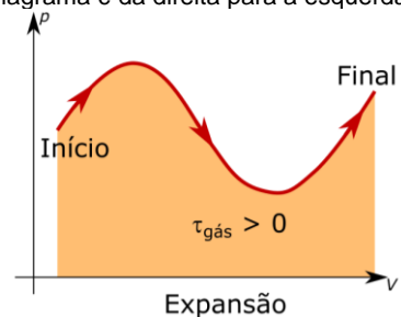
Figura 4: Na expansão, o volume do gás aumenta, portanto o trabalho do gás é positivo.
