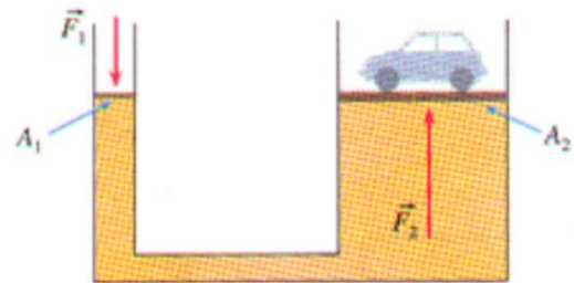
Figura 12: Elevador hidráulico representado por dois tubos de áreas distintas e preenchidos por um líquido.
