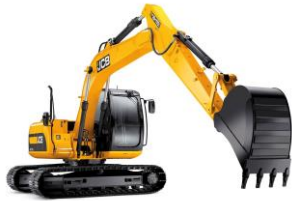
Figura 4: na lagarta da escavadeira, a pressão é menor do que seria se usasse pneus
