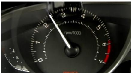
Na figura acima vemos que a rotação do motor está em 2400 rpm (aproximadamente), ou seja, o motor executa 2400 ciclos em um minuto. Dividindo por 60 (número de segundos em um minuto), descobrimos que o motor executa  $2400 / 60 = 40$  ciclos a cada segundo (ou seja, 40 Hz). Chamaremos isso de frequência  $f$  e o inverso disso chamaremos de período  $T = 1/f$ .
