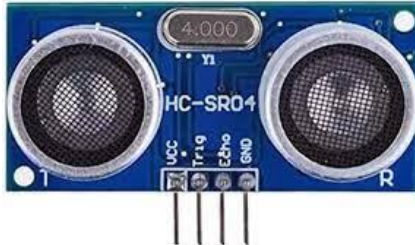
Figura 1: sensor HC-SR04 que utilizaremos na aula de hoje.
