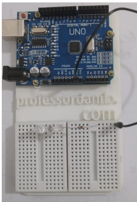
Figura 2:No GND o professor conectou três LEDs, nas cores verde, amarela e azul, olhando da direita para a esquerda. Lembre-se que o LED é polarizado e a perna mais curta deve ser conectada ao GND. O professor colocou, portanto, todos os LEDs com a perna menor do outro lado do resistor.
