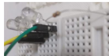
Figura 4: agora conectamos um fio em cada um dos LEDs. O professor escolheu usar os fios nas cores correspondentes às cores do LED. Se quiser ver este material na sua versão colorida, leia o QR-code abaixo.
