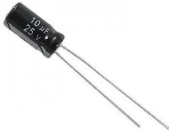
Figura 13: Detalhe de um capacitor eletrolítico. Note que ele é polarizado, sendo a perna maior conectada no positivo e a menor é conectada no negativo.
