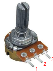
Figura 5: Detalhe de um potenciômetro, como o que cada grupo possui em seu kit. Chamaremos de pino 1 o pino mais a esquerda, pino 2 o central e pino 3 o da direita.
