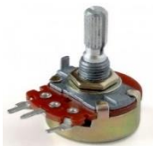
Figura 20: para entendermos o que é um sinal analógico, podemos utilizar o potenciômetro, tal como o utilizado na sala de aula. Note que no nosso primeiro circuito, desta aula, vemos que podemos controlar o brilho do LED alterando o valor da resistência do potenciômetro. Esse é um ótimo exemplo de sinal analógico.
